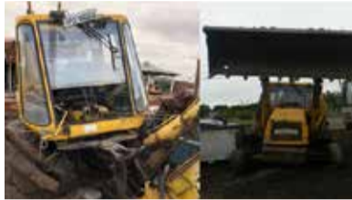
LOTE - 01 BEM - RETROESCAVADEIRA RANDOM MODELO RK 406 B, ANO 2008, TRACÇÃO 4 X 2, MOTOR MWM ASPIRADO C/ 82 HP N° E1N149512, TRANSMISSÃO E EIXOS CARRARO, CABINE FECHADA, CONCHA 30" COM PNEUS DIANTEIROS 10,5/65 X 16, PNEUS TRASEIROS 19,5 X 24, AR CONDICIONADO, CHASSI N° 8A406BMC2W1153 PLACAS IPD 8650;(NECESSITA DE REPAROS) LANCE MÍNIMO (INICIAL) - R$ 15.000,00
