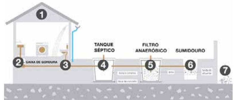
siste em um tanque com pedra brita, alimentado pelo esgoto da fossa séptica. Nele ocorre a fixação e o desenvolvimento de microrga-
