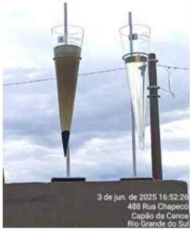
**A esquerda o Afluente (esgoto bruto) e a direita o Efluente (esgoto tratado)**
